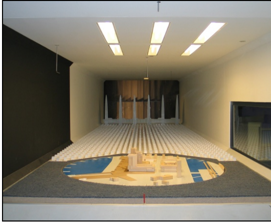
Links: binnenzicht van de windtunnel (kijkrichting tegenstroom), rechts: detailzicht windtunnelmodel.
